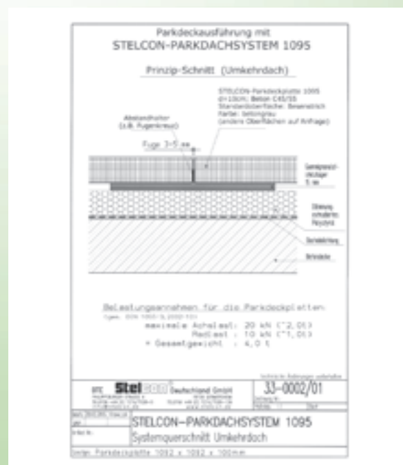
Bild 1: Systemzeichnung Umkehrdach bei Parkflächen
